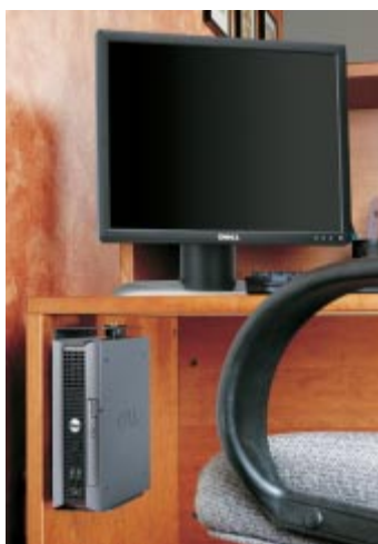
専用ブラケットを使用した設置例
